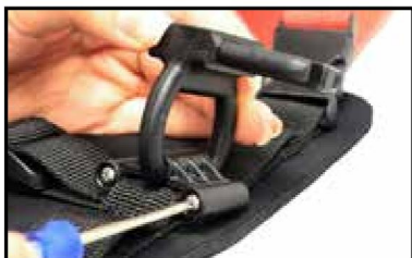
Krok 1: Odstraňte (2) šrouby z (B) horní posuvné spony
